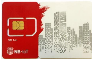
Рисунок 2. SIM-карта с технологией NB-IoT
